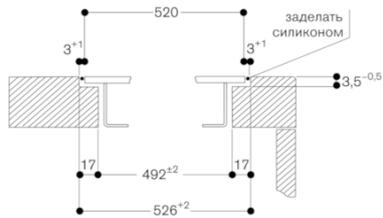
При монтаже с крышкой прибора или выравнивающей планкой, обратите внимание на глубину выреза и ширину заднего и переднего пазов.
